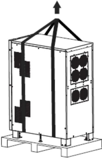
准备两根至少 3 米长，承重至少 1.5 吨的吊绳。将两根吊绳从底部穿过进行吊装。
